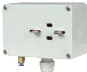
Pneumatisch betätigte Prüfsteckdose für Schuko-Stecker. Die Prüfsteckdose eignet sich für Sicherheits- und Funktionstests. Bei geöffneten Kontakten kann der Stecker nahezu kraftlos eingelegt werden. Die Schutzleiterprüfung wird über zwei zueinander isolierte „Backen“ durchgeführt. Dies ermöglicht die Durchführung einer 4-Leiter-Messung. Gehäuse aus isolierendem Kunststoff. B=120, T=80, H=75 mm
