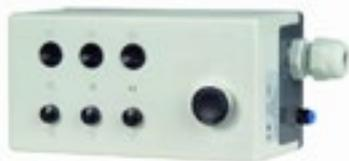
Die Leitungsklemmbox dient zur Kontaktierung von bis zu 3 Leitungen mit freien Kabelenden. Durch kraftfreies Einstecken der Leitung wird diese pneumatisch geklemmt. Über eine zentrale Öffnungstaste lassen sich alle Leitungen gleichzeitig wieder auswerfen. Der Klemmlochdurchmesser beträgt 4 mm.
