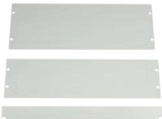
Aluminium-Leerplatten dienen dem Verschließen von offenem Einbauraum in Gehäusen oder Racks. Pulverbeschichtete (ähnlich RAL 7035) Aluminiumplatten 3 mm. Auf der Leerplattenrückseite ist ein Erdungsbolzen M5 aufgeschweißt.
