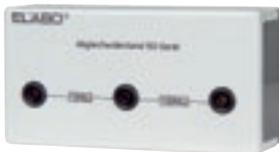
Widerstandskombination eingebaut in ein isolierendes Kunststoffgehäuse für die turnusmäßige Überprüfung von Isolationswiderstandsmessgeräten.
