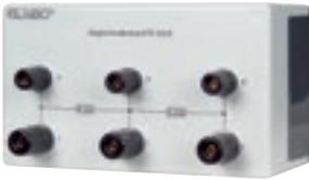
Widerstandskombination eingebaut in ein isolierendes Kunststoffgehäuse für die turnusmäßige Überprüfung von Schutzleiterwiderstandsmessgeräten. Nicht für Dauerbetrieb geeignet.
