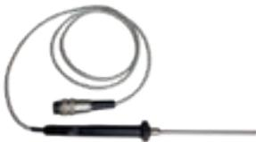
Temperatursonde zur Widerstandsmessung mit Temperaturkompensation. Leitungslänge ca. 1,0 m inkl. 5-pol. Anschlussstecker zum Anschluss an das Widerstandsmessgerät 92-5K.
