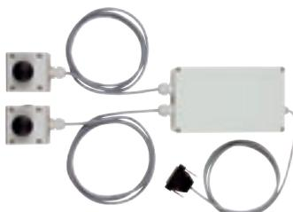
Nach EN50191 ist bei Verwendung von fest angeschlossenen Prüfleitungen die Verwendung einer Zweihandbedienung nach EN 574 Typ IIIC und EN 354-1 am Prüfplatz unerlässlich. Das Sicherheitszweihandrelais besteht aus einer Auswerteeinheit und zwei separaten Drucktastern. Die Einheit kann direkt an ELABO-Hochspannungsprüfgeräte angeschlossen werden.
