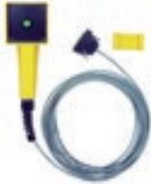
Handstarttaster zum Start der Hochspannungs- und Isolationswiderstandsprüfung in Kombination mit einer Prüfpistole und einem Adapterkabel für den PE. Hierdurch wird vermieden, dass bei der Prüfung eine Hand frei bleibt. Lieferung inklusive Anschlussleitung (ca. 6 m), Wandhalterung und Steckverbinder zum Anschluss an das Prüfgerät.
