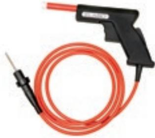
ELABO Sicherheits-Prüfpistole mit Hochspannungskabel und speziellem Hochspannungsstecker. Die Prüfpistole ist bis zu einer Spannung von 8kV AC / 10 kV DC zugelassen. Wird das Prüfgerät mit einem Adapterkabel betrieben, so ist zusätzlich zur Prüfpistole ein Handstarttaster erforderlich. \*
