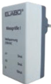
Widerstandskombination eingebaut in ein isolierendes Kunststoffgehäuse für die turnusmäßige Überprüfung von Ableitstrommessgeräten.
