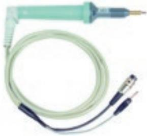
Die Prüfsonde dient der Adaption des Prüfobjekts zur Schutzleiterwiderstandsmessung. Die Prüfsonde kann nicht direkt an das Prüfgerät angeschlossen werden. Die Einheit kann über den Einbausatz 94-4S ZES an ein externes Umschaltfeld oder direkt an den Systemeinschub F9-7M angeschlossen werden. Die Prüfung wird nach Eindrücken der Spitze automatisch gestartet. Ausführung mit Fühlerleitung zur Vierleitermessung.
