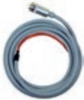
Anschlusskabel mit 7-poligem Systemsteckverbinder zum Anschluss des Prüfobjekts an das Prüfgerät. Typisch in Kombination mit einer Hochspannungs-Prüfpistole und einem Handstarttaster. Zweipolige Ausführung zur Adaption des Schutzleiters nach dem 4-Leiter-Messprinzip. Andere Leitungslängen / Ausführungen auf Anfrage.
