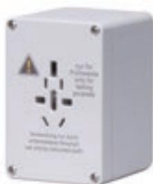
ELABO Universal-Prüfsteckdose Schutzklasse I. Es können verschiedene symmetrische Länderstecker der Schutzklassen I und II in der Prüfsteckdose zur Sicherheits- und Funktionsprüfung kontaktiert werden. Bitte beachten Sie, dass die Prüfsteckdose keinen ausreichenden Berührungsschutz bietet, weshalb diese nur mit Zusatzabsicherung verwendet werden darf. Es werden zwei unterschiedliche Varianten zum Ein- oder Aufbau angeboten. B=120, T=80, H=85 mm
