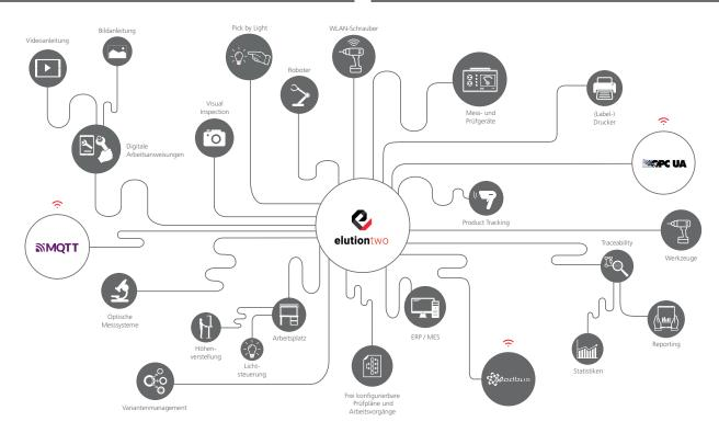
Die MQTT Schnittstelle ist ein offenes Nachrichtenprotokoll, welches sich zum Standardprotokoll für IOT- bzw. Machine-to-Machine-Kommunikation von Geräten und Applikationen entwickelt hat. So können zukünftig MQTT-fähige Geräte direkt mit der elution two kommunizieren.
