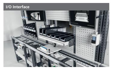
Das I/O Interface ermöglicht es, selbstständig digitale Ein- und Ausgänge in den Prozess einzubinden. Das können Sensoren und Aktoren sein, die Ihren Prozess überwachen, steuern oder mit zusätzlichen Informationen anreichern. So könnten beispielsweise Umgebungsbedingungen wie Temperatur oder Luftfeuchtigkeit erfasst werden.
