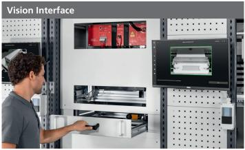
Das Vision Interface ermöglicht Ihnen eine automatische Prüfung von Bauteilen. So können per Kamera-Technik fehlerhafte Verkabelungen oder Montagen von Bauteilen erkannt werden und das Weitergeben eines falsch montierten Produktes verhindert werden.
